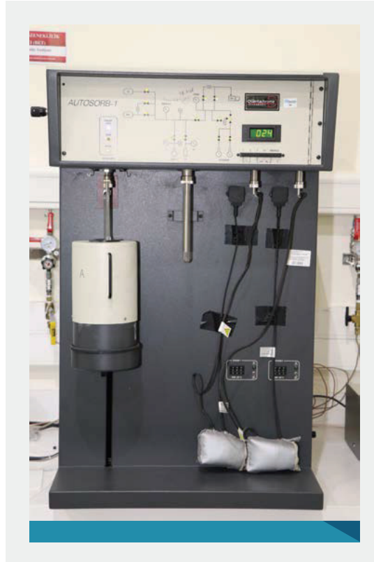
Şekil 12. Quantachrome/Autosorb-1 Marka BET Cihazı
