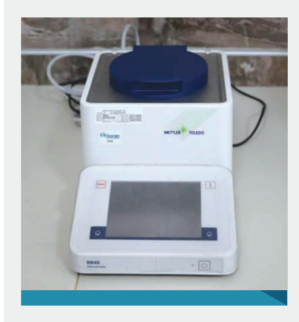
Şekil 24. Mettler Toledo/RM40 Marka Refraktometre
