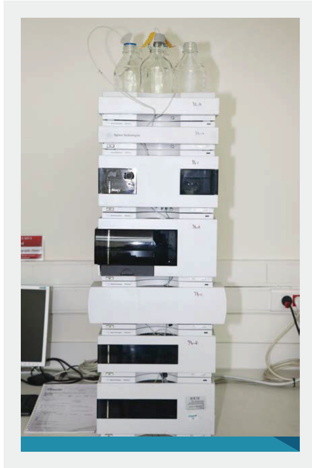
Şekil 11. Agilent Technologies/1260 Infinity II Marka GPC Cihazı
