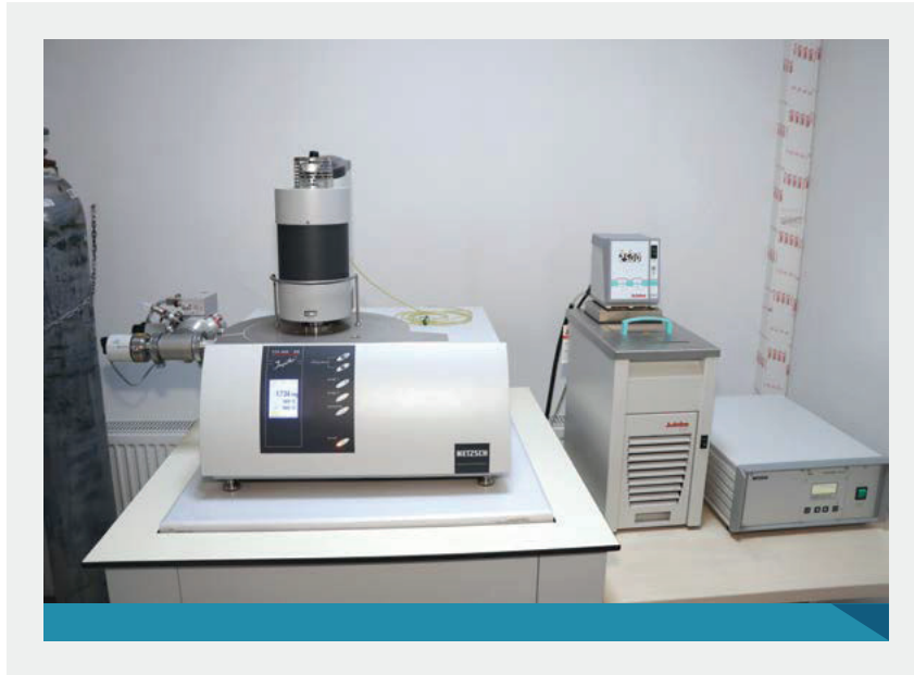
Şekil 15. Netzsch/STA 449 F3 Jüpiter Marka TG-DTA/DSC Cihazı
