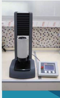
Şekil 26. Emcotest/Durajet Marka Rockwell Sertlik Ölçme Cihazı
