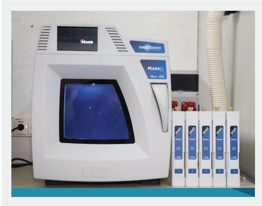
Şekil 2. Cem/Mars 6 Marka Mikrodalga Cihazı
