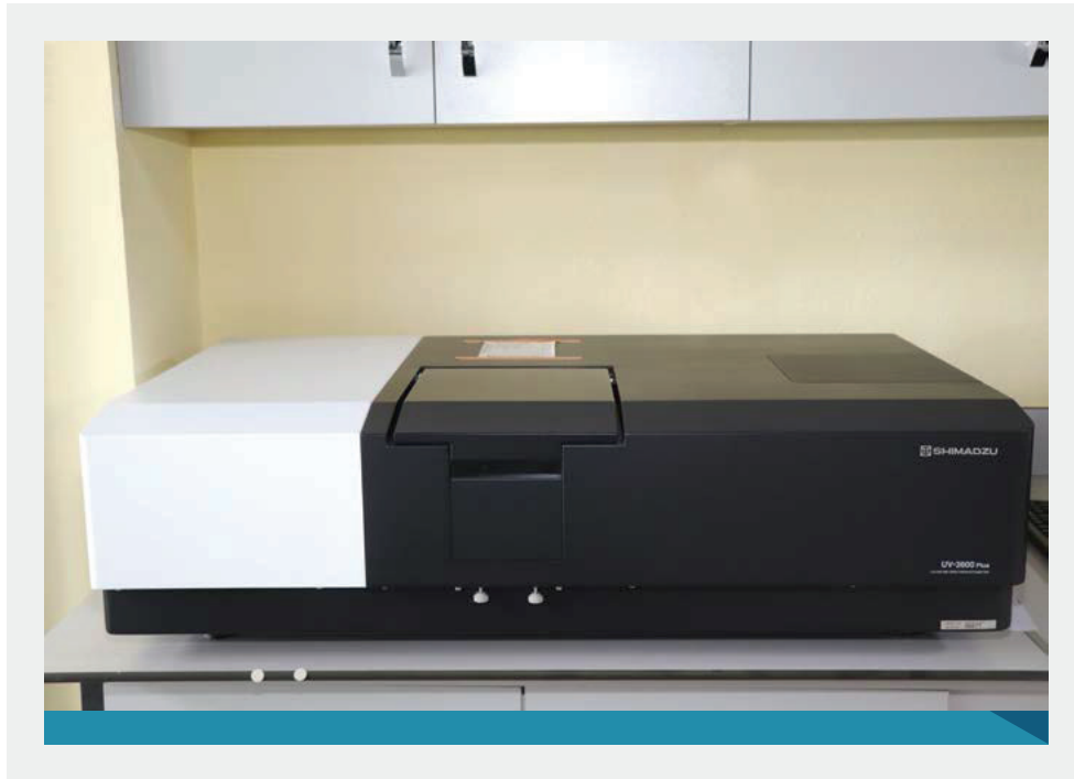
Şekil 7. Shimadzu/UV 3600 Plus Marka UV-VIS-NIR Spektrofotometre Cihazı
