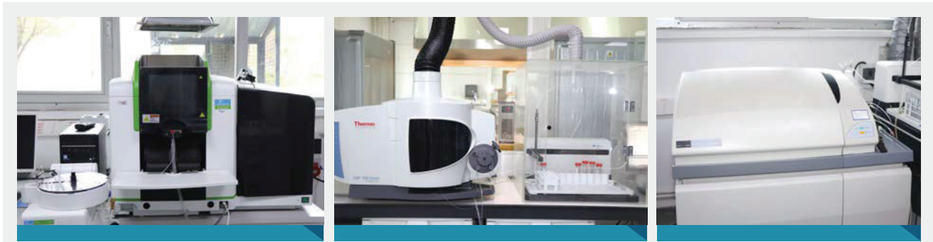
Şekil 4. Perkin Elmer / PinAAcle 900 T Marka AAS Cihazı
