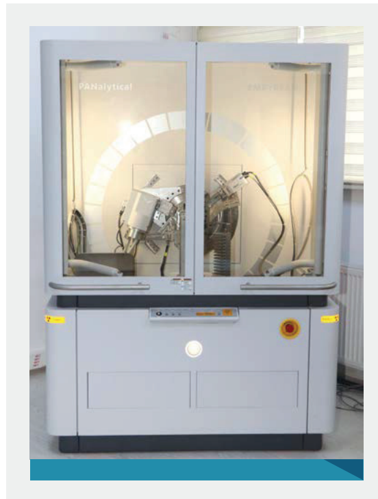
Şekil 3. PANalytical/Empreyan marka XRD Cihazı
