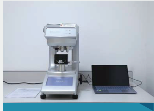
Şekil 27. Shimadzu HMV-G Marka Vickers Sertlik Ölçme Cihazı
