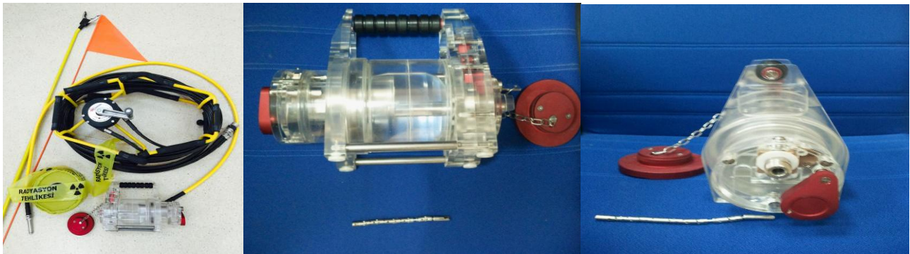
Resim 16. Endüstriyel radyografide radyasyondan korunma eğitiminde kullanılan demo ekipmanları
