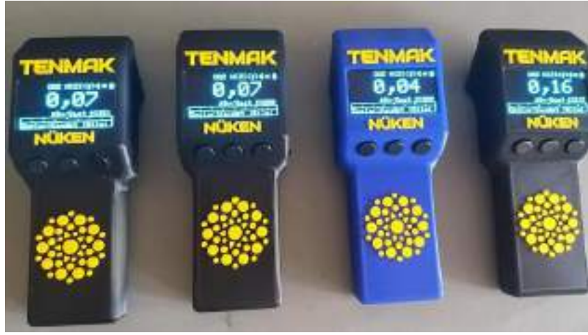
Resim 11: İyileştirme Çalışmaları Kapsamında İmalatı Yapılan El Dedektörleri
